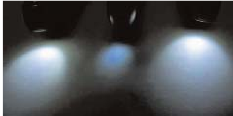
Abb. 4: Im Vergleich mit dem Licht der NSK LED-Turbinenkupplung fallen die unnatürlich blaue Farbe, die niedrige Beleuchtungsstärke und der kleine Lichtkegel der LED-Birne auf.
