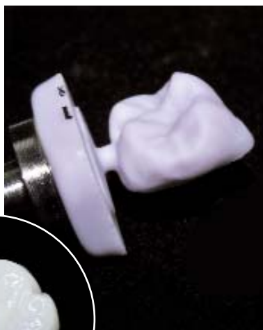
Oben: Gefräster Rohling in der „blauen Phase“ (Material: IPS e.max CAD, Ivoclar Vivadent). – Links: Fertiggestellte Vollkeramik-Krone.
