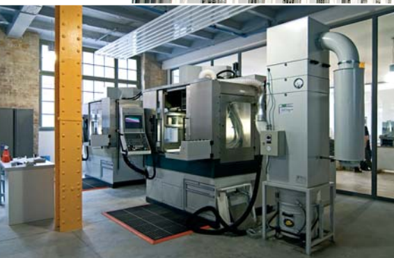
Oben: Die neue Produktionsstätte der biodentis GmbH in Leipzig-Plagwitz. Links: Der Produktionsraum mit hochpräzisen vollautomatisch gesteuerten 5-Achs-Fräsmaschinen.
