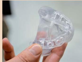
Passgenaue, maschinell erstellte Bohrerschablone.
