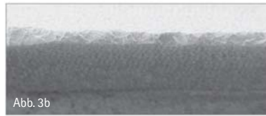
Abb. 3: VITA ENAMIC zeigt eine hohe Kantenstabilität auch in dünn auslaufenden Randbereichen. Abb. 3b–c: Aufsicht 30°-Keile: links VITA ENAMIC (Vergrößerung 200-fach), rechts traditionelle CAD/CAM-Keramik (Vergrößerung 200-fach).
