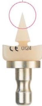
Abb. 3: VITA ENAMIC zeigt eine hohe Kantenstabilität auch in dünn auslaufenden Randbereichen. Abb. 3b–c: Aufsicht 30°-Keile: links VITA ENAMIC (Vergrößerung 200-fach), rechts traditionelle CAD/CAM-Keramik (Vergrößerung 200-fach).
