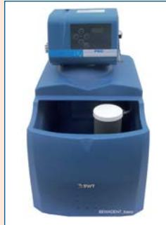
Der Wasserenthärter BEWADENT\_basic von aquaPROdentis ist speziell für den Praxisbetrieb bei hoher Wasserhärte konzipiert und die typisch geringen Wasserverbrauchsmengen. Ebenso ist er DVGW-geprüft nach DIN 19636 und trägt das CE-Zeichen. Die Anlage beruht auf dem seit Jahrzehnten bewährten Ionenaustauscher-Prinzip und bietet sicheren Schutz vor Verkeimung durch eine tägliche automatische Desinfektion. Die integrierte differenzdruckgesteuerte Verschnelung gewährleistet auch
