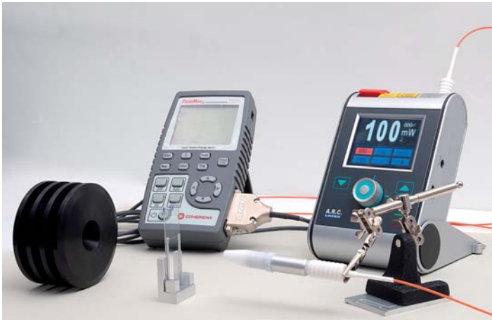
Abb. 5: Aufbau Transmissionsmessung EmunDo® (ARC Laser 2012).
