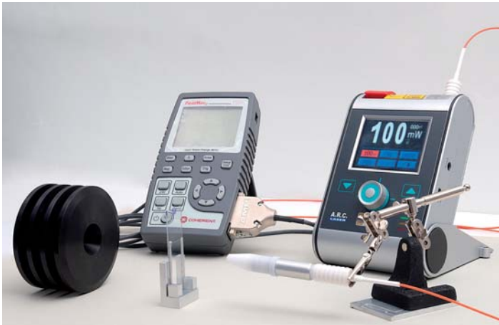
Abb. 5: Aufbau Transmissionsmessung EmunDo® (ARC Laser 2012).
