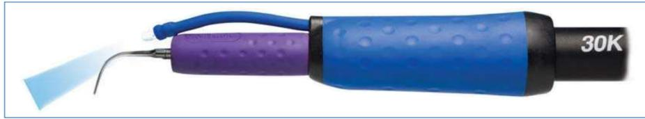
Dank Induktion kommt das System ohne zusätzliches Kabel und ohne externe Stromversorgung aus, indem der Aufsatz mit dem LED-Lichtleiter einfach auf das Steri-Mate-Handstück gesteckt und anschließend die gewünschte Arbeitsspitze in das Handstück eingesetzt wird. Durch den flexiblen Lichtleiter lässt sich der Lichtkegel optimal zur Arbeitsspitze ausrichten. So ist das Beleuchtungssystem sofort einsetzbar und geht in Betrieb, sobald Ultraschall angefordert wird. Es funktioniert bei allen Leistungs-
