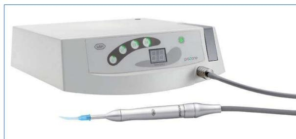
tika zerstört Ozon alle Bakterien (durch Oxidation); eine Resistenz ist nicht möglich. Prozone, der neue Ozon-Generator von W&H, produziert das Gasgemisch durch Corona-Entladung. Dabei wird Luft in das Gerät gepumpt, durch einen speziellen Filter getrocknet und gereinigt und anschließend in eine Kammer weitergeleitet, wo sie durch
