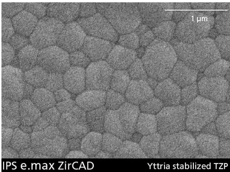
Abb. 6: Mikrostruktur der dichtgesinterten IPS e.max ZirCAD-Keramik. Sichtbar ist das feinkristalline, dichte und porenfreie Gefüge mit einer mittleren Kristallitgröße von 0,5 µm.
