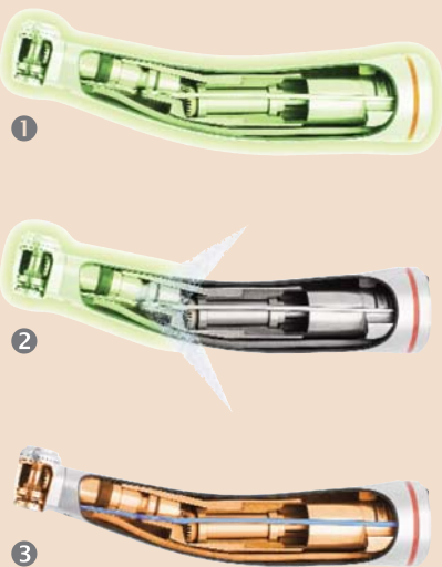
1: Innenreinigung der Spraykanäle und Getriebeteile, Aussenreinigung des Instruments. – 2: Durchblasen der Spraykanäle mittels Druckluft. – 3: Schmierung der Getriebeteile mit W&H Service Oil F1.
