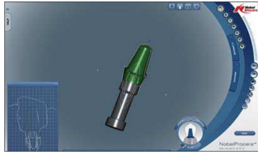
Abb. 5a–b: Mit einem modernen CAD/CAM-System (NobelProcera™ Scanner, Nobel Biocare) und einer fortschrittlichen Software lassen sich zeit- und kostenintensive Arbeitsschritte bei der Konstruktion der Gerüste (hier individuelles Implantatabutment) im Labor minimieren (NobelProcera™ Software, Nobel Biocare).
