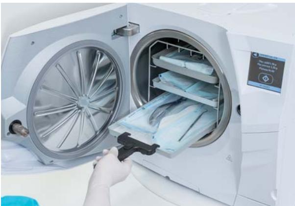
Die Sterilisation ist grundsätzlich mit einem geeigneten Dampfsterilisateur der Klasse B und mit feuchter Hitze durchzuführen. Die Aufbereitung endet mit der dokumentierten Freigabe zur Lagerung bzw. zur erneuten Anwendung.
