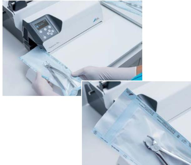
Das desinfizierte Instrument wird nun in ein Sterilgutbarriersystem (z.B. Hygofol von Dürr Dental) verpackt und sicher versiegelt (z.B. Hygopac Plus System von Dürr Dental). Dabei ist auf eine einwandfreie Siegelnaht zu achten.
