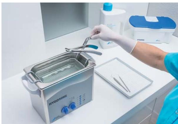
Instrumente der Klassen „unkritisch“, „semikritisch“ und auch „kritisch A“ können alternativ zur maschinellen Aufbereitung auch durch chemische Verfahren gereinigt und desinfiziert werden. Die verwendeten Desinfektionsmittel müssen dabei bakterizid, tuberkulozid, fungizid sowie (voll)-viruzid sein (z.B. ID 213 Instrumentendesinfektion von Dürr Dental). Besonders schnelle Einwirkzeiten erhält man durch den Einsatz eines Ultraschallgerätes (z.B. Hygasonic von Dürr Dental).
