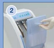
Nachdem die Instrumente eingesetzt wurden, wird der Deckel wieder geschlossen. Der Care3 Plus-Pflegeprozess startet nur, wenn die Tür richtig geschlossen ist.
