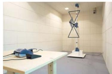
Messvorrichtung für von Produkten abgestrahlte elektromagnetische Wellen.
