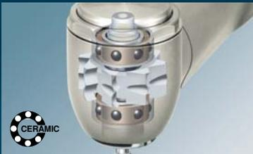
Da Keramik 25% härter ist als Edelstahl, sind Beschädigungen noch unwahrscheinlicher, sollten doch einmal Fremdkörper in die Turbine eindringen. Keramik ist auch 50% leichter als Edelstahl, wodurch sich die Friktion am Kugellagerkäfig verringert. Diese beiden Faktoren zusammen erhöhen deutlich die Lebensdauer der Lager.
