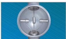
Die Doppelstrahldüsen leiten Luft in die Pulverkammer, wodurch ständig Pulver zur zentralen Saugdüse gedrückt wird. Durch die runde Form des Pulverbehälters bleiben keine Reste zurück. Dieses System strahlt gleichmäßig und genau, wodurch ein hervorragendes Polierergebnis erzielt wird.
