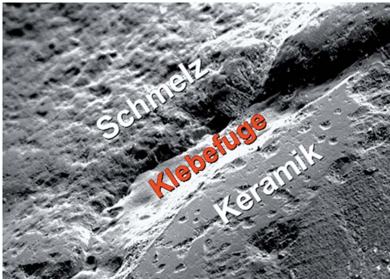
Abb. 2: Klebefuge zwischen Schmelz und Glaskeramik. (REM-Foto: Frankenberger)
