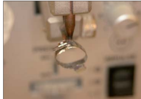
Abb. 5: Anpunkten der palatinalen Schlösser an die Molarenbänder.
