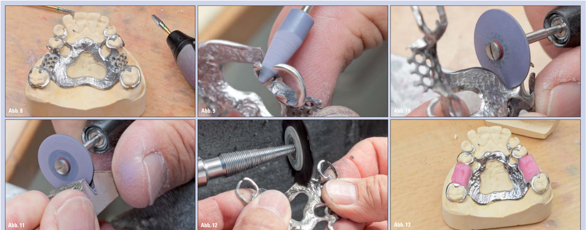
Abb. 8: ... er eignet sich auch bestens für die Oberflächenanrabung. – Abb. 9: Zusammen mit den NEX-Fräsern ergeben die Komet NEM-Polierer ein „schlaues System“. – Abb. 10: Die Linsenform gelangt überall hin und schont die breiteren Polierräder. – Abb. 11: Ein besonderer Tipp: Mit dem Abrichtblock von Komet lässt sich jeder Polierer in die gewünschte Form bringen. – Abb. 12: Effektiv und bewährt: Modellgusspolitur am Poliermotor. – Abb. 13: Vorausschauend geplant – Die skelletierte Form kann leicht erweitert werden.
