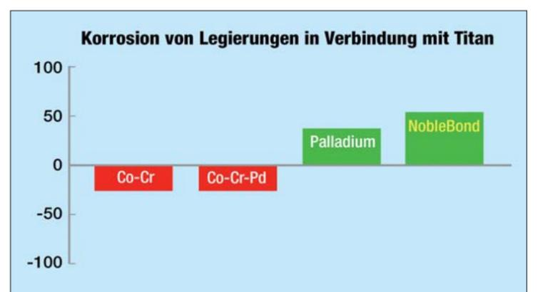
essenten telefonisch bei ARGEN Dental anfordern. NobleBond™ besteht aus 40 Prozent Kobalt, 25 Prozent Ruthenium, 24 Prozent Chrom, 11 Prozent Gallium und unter 1 Prozent Bor. Durch die Korrosionsfreiheit in Verbindung mit Titan ist es eine sichere NEM-basierte Aufbrennlegierung mit starker Festigkeit und neutralem WAK-Wert für jede Metallkeramik-Anwendung. Weitere Vorteile sind, dass mehr Einheiten bei geringerer Dichte (9,0g/cm<sup>3</sup>) er-
