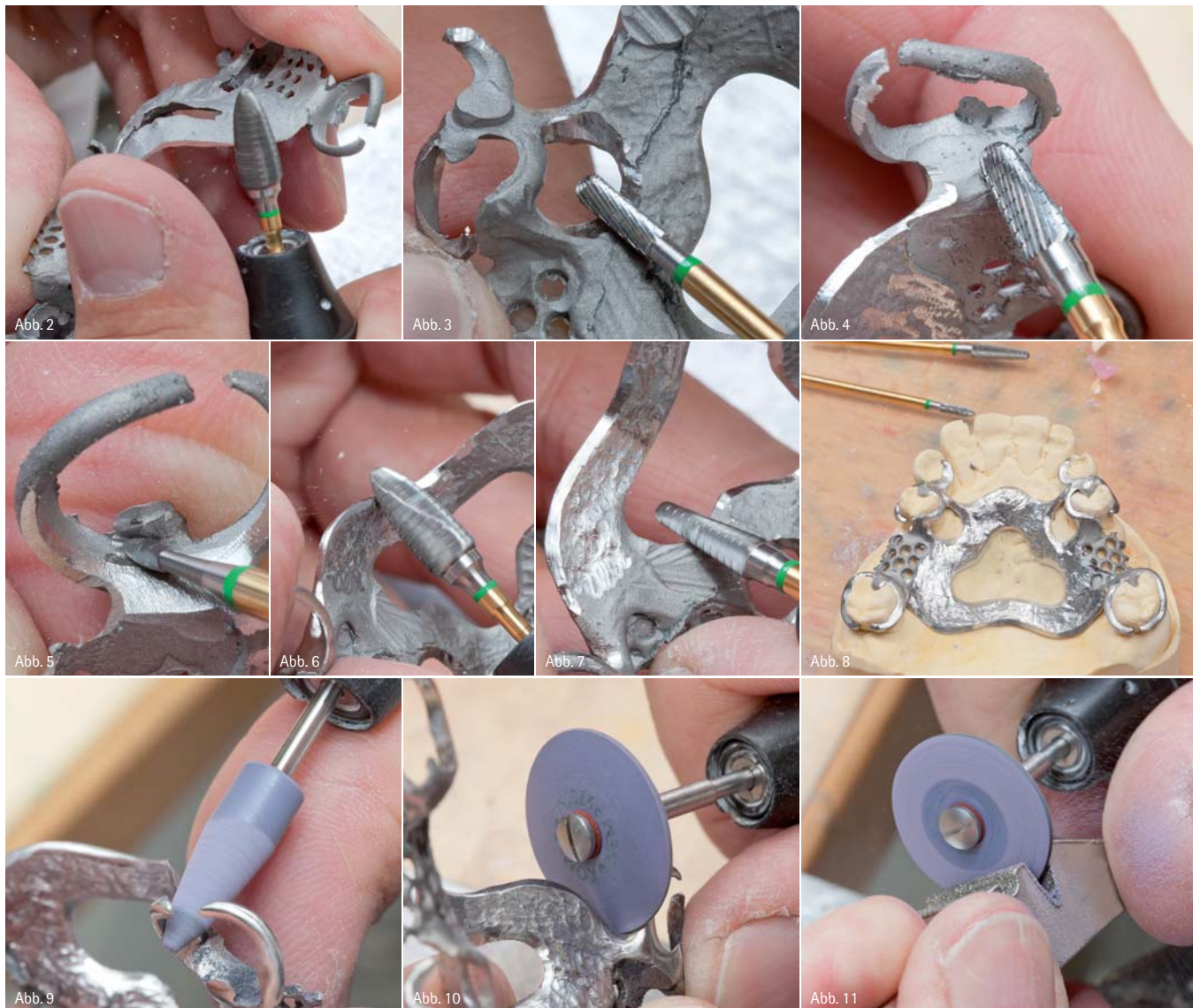
Abb. 2: Mit dem großen NEX-Fräser H251 glättet der Zahntechnikermeister die dorsale Außenform und entfernt die Überreste der Gusskanäle. Der Fräser trägt dabei ordentlich ab. – Abb. 3: Die Öffnung für das Parodontium zieht ZTM Starke mit der Form H129 nach. – Abb. 4: Ein Fräser mit einem kleinen Arbeitsteil eignet sich hervorragend für Halteelemente und Auflagen. – Abb. 5: Für Gussperlen innen an Klammerarmen ist die Ei H73 perfekt. Sie wölbt sich wie die Zahnwölbung. – Abb. 6: Effektiver Materialabtrag bei gleichzeitig glatten Oberflächen – NEX-Fräser von Komet. – Abb. 7: Wo es eng wird, nutzt man am besten den H79-Fräser ... – Abb. 8: ... er eignet sich auch bestens für die Oberflächenanrührung. – Abb. 9: Zusammen mit den NEX-Fräsern ergeben die Komet NEM-Polierer ein „schlaues System“. – Abb. 10: Die Linsenform gelangt überall hin und schont die breiteren Polierräder. – Abb. 11: Ein besonderer Tipp: Mit dem Abrichtblock von Komet lässt sich jeder Polierer in die gewünschte Form bringen.
