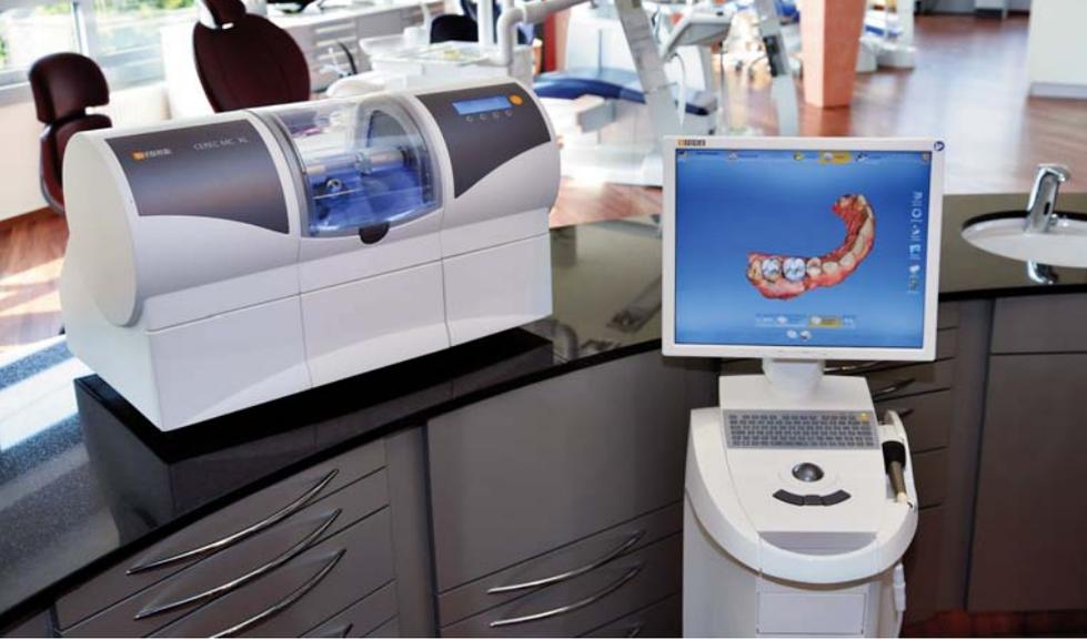
Die Schleifmaschine Sirona CEREC MC XL und der Intraoralscanner und die CEREC Omnicam im Showroom von dental bauer.
