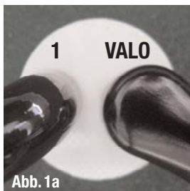
▲ Abb. 1a: Vergleich VALO mit Mitbewerber 1. ▲ Abb. 1b: Beide Leuchten setzen eine deutliche blaue Markierung. ▲ Abb. 1c: Auch hier verursachen beide Leuchten eine Markierung. Die des Mitbewerbers 1 offenbart jedoch, dass das Lichtfeld nicht homogen ist; dies kann dazu führen, dass Komposite nur ungleichmäßig ausgehärtet werden.
