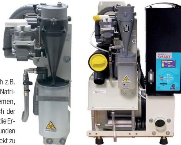
die feinen Amalgamrückstände an die Außenwandungen des sich verjüngenden Amalgamabscheiderkegels geschleudert und in Richtung Abscheidedüse befördert, welche sich direkt vor dem Amalgamsammelbehälter befindet. Genau an dieser Stelle „fallen“ die Amalgamrückstände in den Amalgamsammelbehälter, während das restliche Wasser-Sekret-Gemisch in der Mitte des Kegels wieder aufsteigt und in den
