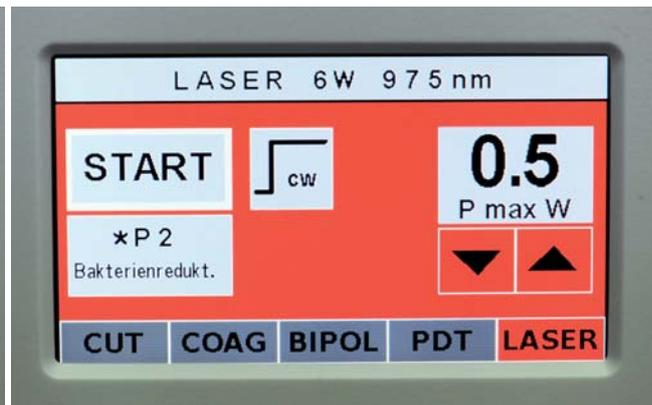
**Abb. 5:** Touchscreen-Display bietet übersichtliche Vorauswahl für verschiedene Indikationsbereiche des Diodenlasers. – **Abb. 6:** Im Untermenü des Gerätes kann nach Programmvorauswahl individuelle Einstellung von Behandlungsparametern erfolgen.
