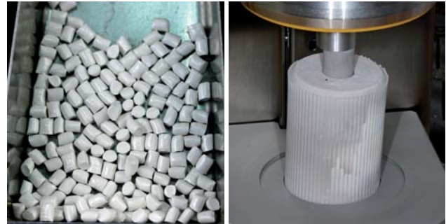
Abb. 4: BioHPP-Filler für ein verbrauchsgenaues Befüllen der Muffel. – Abb. 5: Beendeter Pressvorgang mit Abkühlung unter Druckbeaufschlagung.
