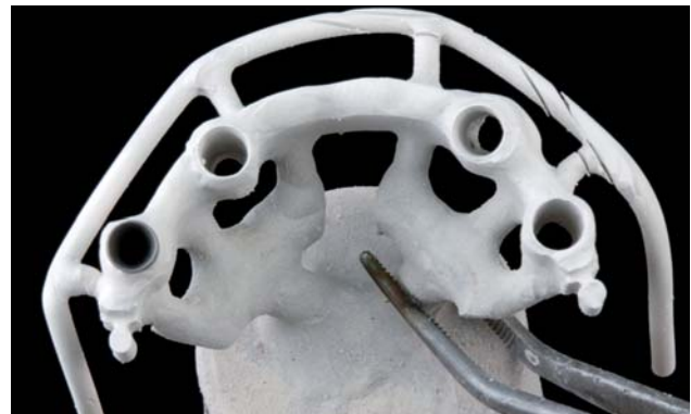
Abb. 12: Stegmodellation aus Wachs, vorbereitet für das for 2 press-Verfahren. – Abb. 13: Ausgebetteter BioHPP-Steg.
