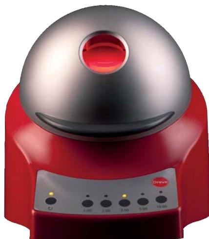
Ausgerüstet mit vier leistungsstarken LEDs und den Spektralbereichen 385 + 470 nm ist EyeEvolution® für alle marktüblichen Basismaterialien einsetzbar. Zudem ist eine thermische Belastung der Werkstoffe ausgeschlossen. Ein verspiegelter, elektrischer Drehteller sorgt für einen nahezu schattenfreien Lichteinfall auf das Werkstück.
