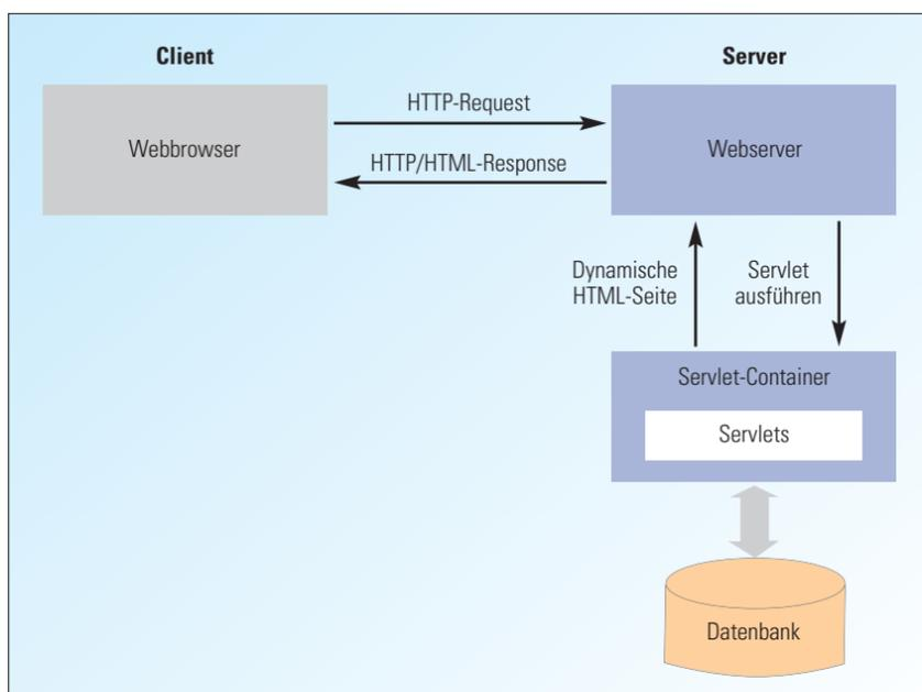
Abb. 1: Ablauf der dynamischen Seitengenerierung mit Java-Servlets.
