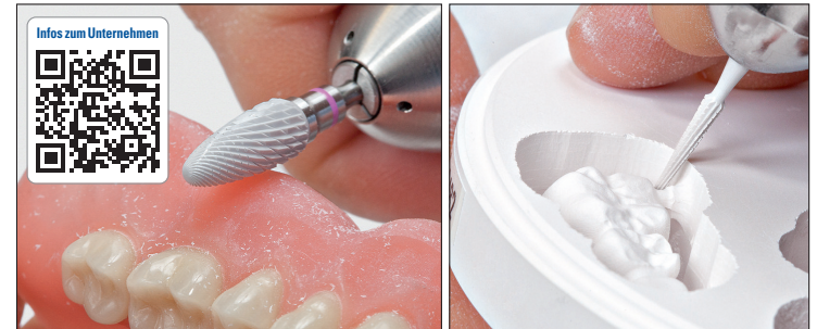
Zeit sparen mit dem keramischen Dualfräser K251EQ.104.060 – beim Ausarbeiten von Prothesen und bei Korrekturen am Stuhl (links). – Der K261GSQ.104.023 eignet sich hervorragend zur Bearbeitung von Kunststoffprothesen sowie zum Herausstrennen von Weißlingen aus der gefrästen ZrO 2 Ronde (rechts).
