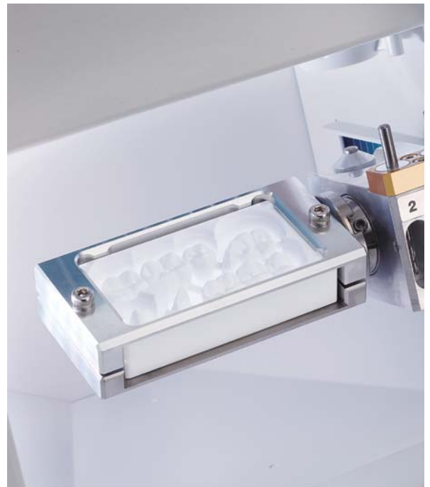
Fräsen von Kronen, kleinen Brücken (bis zu 4 Gliedern), Inlays/Onlays aus Zirkonoxid, PMMA, Hochleistungspolymeren und Wachs.
