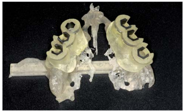
Abb. 4: Stereolithografisches Modell mit den geteilten Bohrschablonen.
