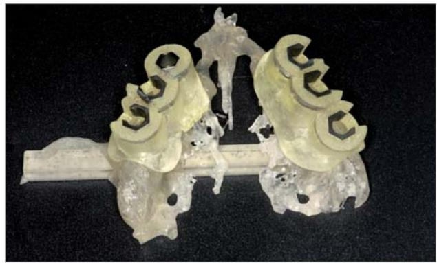
Abb. 4: Stereolithografisches Modell mit den geteilten Bohrschablonen.
