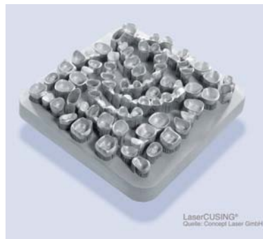
Mit der Metall-Laserschmelztechnik gefertigte Kronen und Brücken (l.) und Modellgussteile, gefertigt mit LaserCUSING® (r.).
