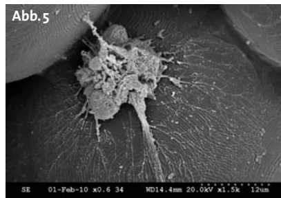
Abb. 3 und 4: REM-Aufnahmen der F 2 - und F 3 -Implantatoberflächen. – Abb. 5 und 6: SaOs-2-Zellen auf den F 2 - und F 3 -Implantatoberflächen.
