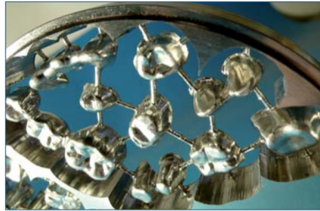
Ein patentiertes Absaugverfahren ermöglicht das schnelle Umrüsten von Trockenbearbeitung für Keramiken wie Zirkonoxid zu Nassbearbeitung für unterschiedliche Metalle, wie hier das Fräsen von Kappchen im Cluster.
