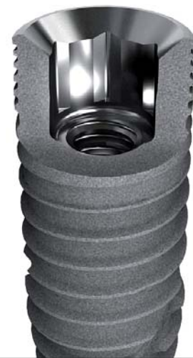
Abb. 6: Bewährte konische Innenverbindung: mit 45° mittlerem Konuswinkel und Rotationssicherung durch Innensechskant sowie integriertes Platform Switching.
