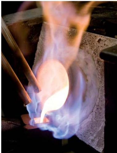
Abb. 2: Die chargierten Materialien werden unter Schutzgas induktiv erschmolzen.
