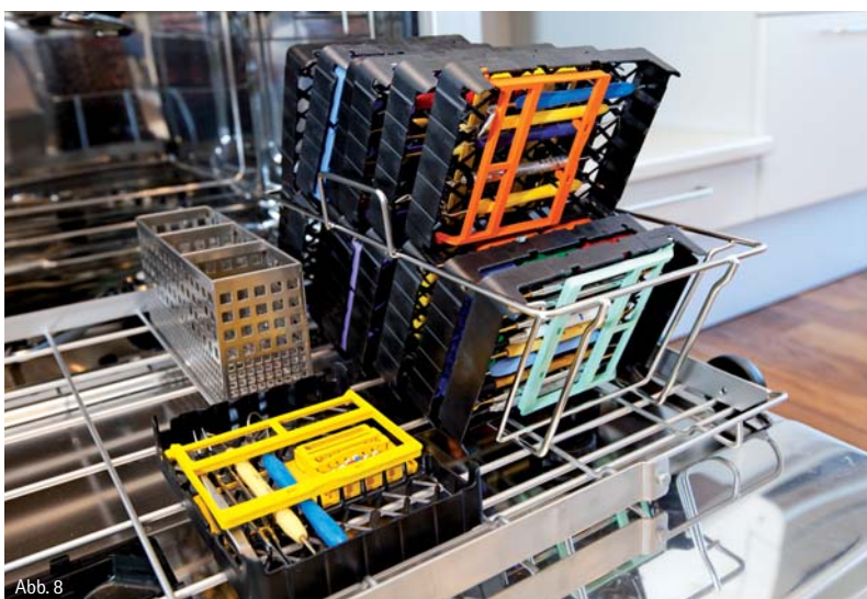
Abb. 8: Genau wie beim Autoklaven müssen Reinigungs- und Desinfektionsgeräte nunmehr validiert und dann jährlich von einem zugelassenen Servicetechniker einer Prozesskontrolle unterzogen werden (UPK).
