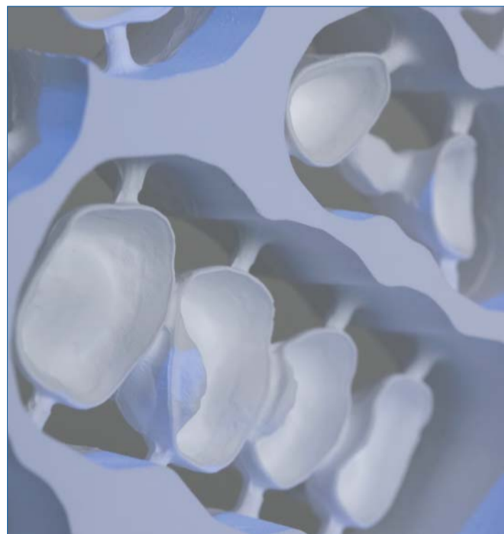
DD Bio ZZ – eine optimierte Rohlingsgeometrie erlaubt es, Einzelkronen, kleine und große Brückengerüste aus einem Rohling zu fräsen.
