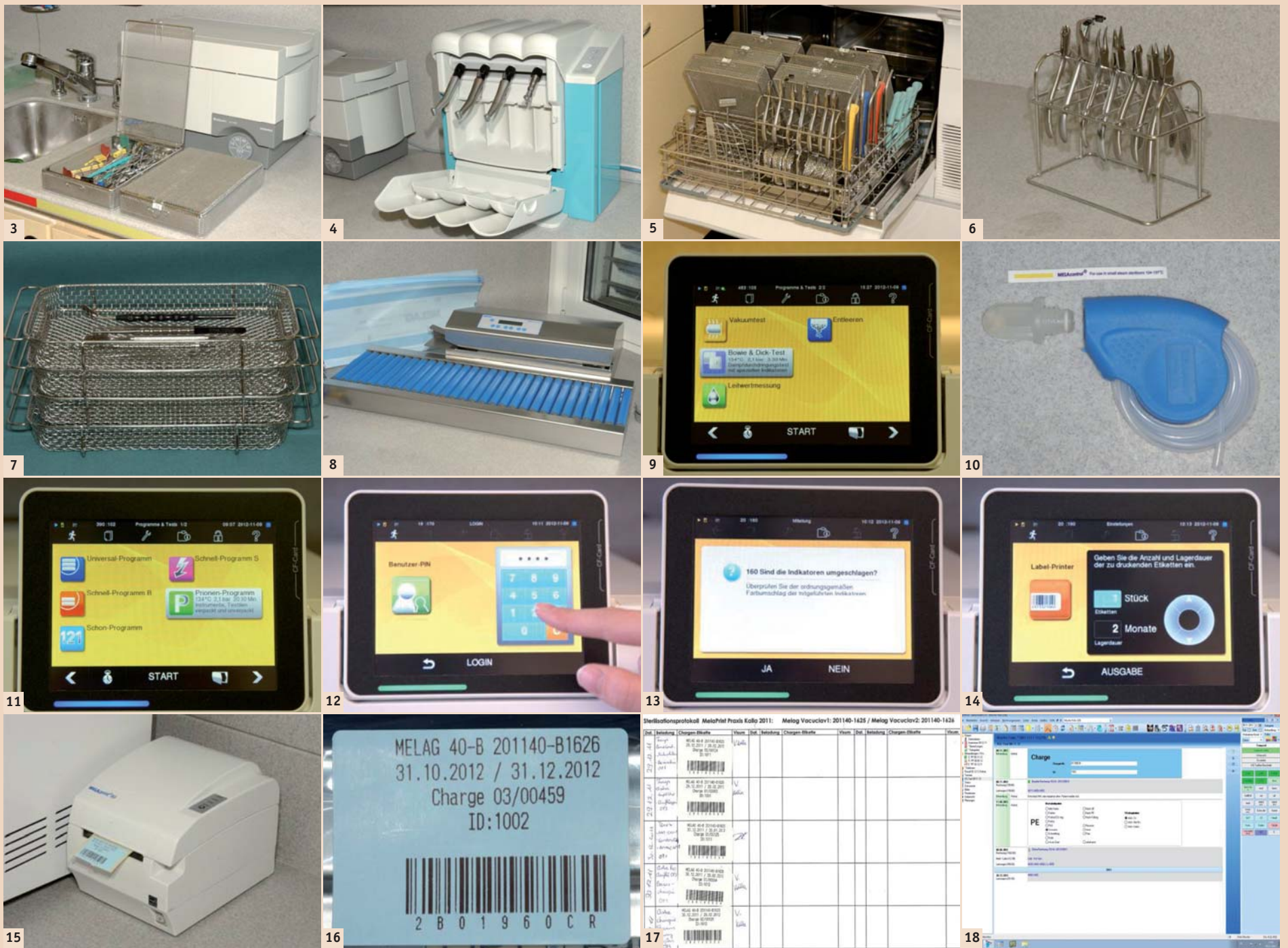
Abb. 3: Reinigungs-Instrumentenbehälter mit Deckel vor Ultraschallbad (COLTENE: Biosonic UC100 für Einzelinstrumente und UC300 für Kassetten/Körbe). – Abb. 4: Pflege- und Reinigungssystem für Winkelstücke (KaVo: QUATTROcare). – Abb. 5: Haltesystem für Saugkanülen: Reinigung von innen und außen. – Abb. 6: Reinigungs-Haltesystem für Zangen für Ultraschall und Thermodesinfektor. – Abb. 7: Offene, stapelbare Instrumentenkörbe. – Abb. 8: Folienbeutel-Schweißsystem (MELAG: MELAseal Pro). – Abb. 9: Prüfprogramme am Autoklaven (MELAG Vacuclav 40B+). – Abb. 10: Prüfkörper für den „Bowie & Dick-Test“. – Abb. 11: Touchscreen am Autoklaven für die Dateneingabe: Programmwahl für die manuelle Dateneingabe und Anzeige der jeweiligen Traybestückungen. – Abb. 12: Eingabe des persönlichen Identifikationscodes. – Abb. 13: Bestätigen des Farbumschlages des Indikators. – Abb. 14: Eingabe der Etikettendaten. – Abb. 15: Etikettendrucker MELAprint 60. – Abb. 16: Chargen-Einfach-Klebetiketten (blau). – Abb. 17: Manuelle Beladungsliste mit Chargenetiketten. – Abb. 18: Chargendaten in der elektronischen Krankengeschichte (Beispiel: ZaWin4).
