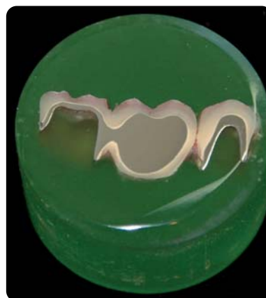
Abb. 3: Schliffbildprobe eines lasergesinterten Gerüsts aus CoCr.
