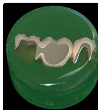
Abb. 3: Schliffbildprobe eines lasergesinterten Gerüsts aus CoCr.
