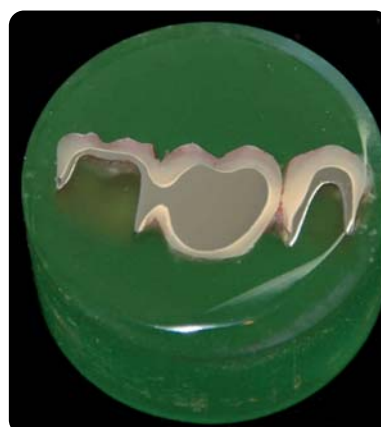
Abb. 3: Schliffbildprobe eines lasergesinterten Gerüsts aus CoCr.
