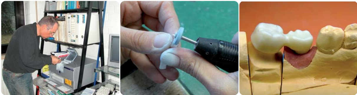
Abb. 8: Einspannen des Blockes und Schleifvorgang mit inLab. – Abb. 9: Beschleifen des gefrästen Gerüsts nach dem Trennen vom Block. – Abb. 10: Einpassen des Brückengerüsts.
