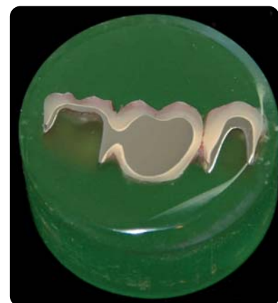
Abb. 3: Schliffbildprobe eines lasergesinterten Gerüsts aus CoCr.
