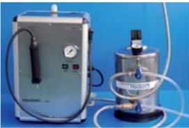
**Hedent Inkoquell 6** ist ein Wasser- aufbereitungsgerät zur Versorgung von Dampfstrahlgeräten mit kalkfreiem Wasser bei automatischer Kesselfüllung.
