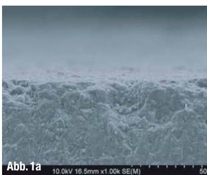
▲ Abb. 1a–1c: Vergleich der Abrasion von Fuji IX GP Extra (entsprechend EQUIA Fil) mit und ohne G-Coat Plus (entsprechend EQUIA Coat) nach 20.000 Zyklen (Quelle: Kato K, Yachimizu H, Nakaseko H, Sakuma T: Influence of coating materials on conventional glass-ionomer cement. Abstract 487. IADR 2008, Toronto, Canada). ▲ Abb. 1a: Ohne Coating. ▲ Abb. 1b: Mit G-Coat Plus. ▲ Abb. 1c: Mit Biscover LV.
