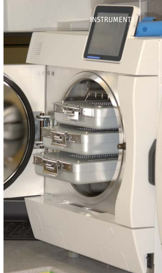
Abb. 6: Bestückung eines Autoklaven mit drei Steril-containern für ein Tray.
