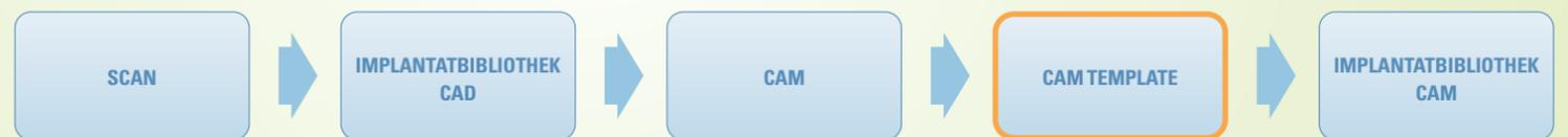
Hochinteressant wird es beim Schritt CAM-Template, der hier beispielhaft beschrieben wird. Das Template ist die Definition der geplanten Werkstoffbearbeitung. Hier legt man den Werkzeugeinsatz (Bohrer oder Fräser) und die verwendete Werkzeuggeometrie (z.B. Kugel oder Torus) fest. Dazu kommen die Schnittparameter, wie Drehzahlen, Zustellungswerte und Vorschübe. Und die Bearbeitungsarten, in denen die Fräswege (Fräsbahnen) und die Reihenfolge der Bearbeitung be-
