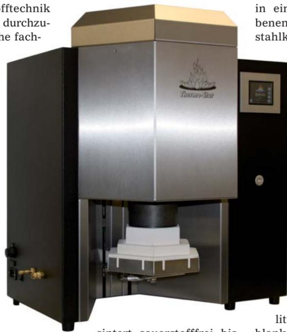
sintert sauerstofffrei bis zu 30 Teile Sintergut in drei Stunden. Die Variante 2 für bis zu 60 Teile benötigt ca. vier Stunden. Ein kostengünstiger Wechsel von Variante 1 zu 2 ist jederzeit möglich.
