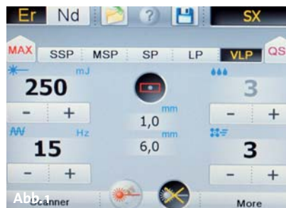
Abb. 1 und 2: Einstellungen am Lightwalker AT Er:YAG, „Advanced Modus“: sichtbar SX als X-Runner-Handstück und die einzelnen Standardeinstellungen für Weichgewebsablation bei sehr langen Pulsdauern, welche allein dank der notwendigen 700 µs oder länger eine effiziente Koagulation gewährleisten. Ausgewählt in diesem Beispiel ist das Rechteck bei einer Fläche von 6 x 1 mm. Zwei der drei geometrischen Voreinstellungen (Kreis, Rechteck, Hexagon) sind schematisch dargestellt als ganzflächig aktiv oder nur in den definierten Randzonen.
