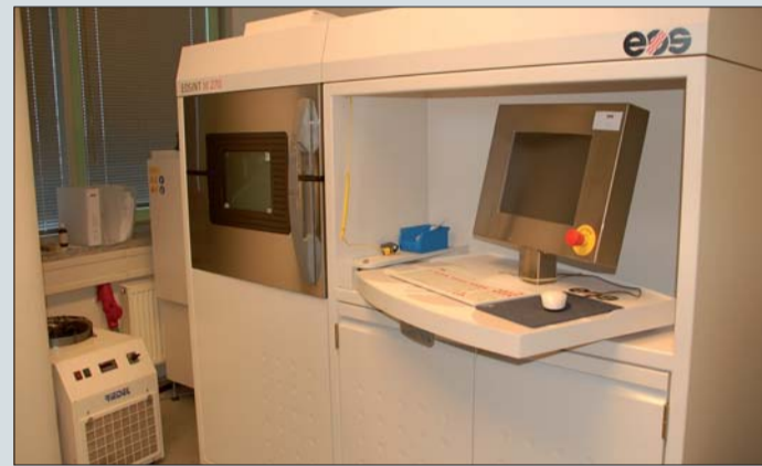
Die Flussfisch GmbH in Hamburg vertraut beim Laser-Sintern auf die Anlage EOSINT M270 der Firma EOS GmbH.
