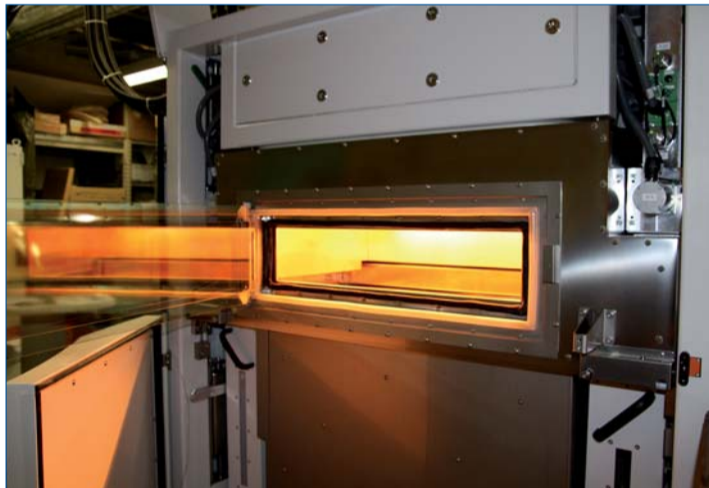
Im Ofen EOSINT P 800 herrschen beim Laser-Sintern Temperaturen von bis zu 385°C.
