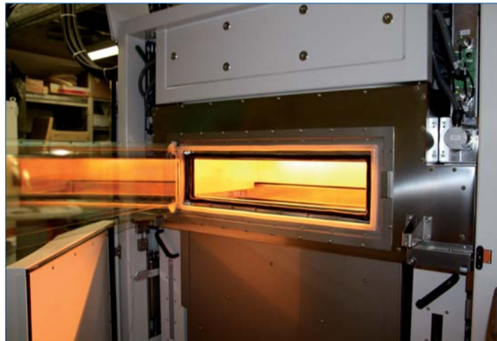
Im Ofen EOSINT P 800 herrschen beim Laser-Sintern Temperaturen von bis zu 385°C.
