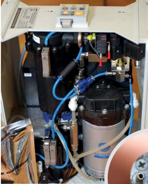
Abb. 2: Freier Auslauf gemäß DIN EN 1717. – Abb. 3: Biofilm und Kalkablagerungen an der Luft-Wasser-Spritze.
