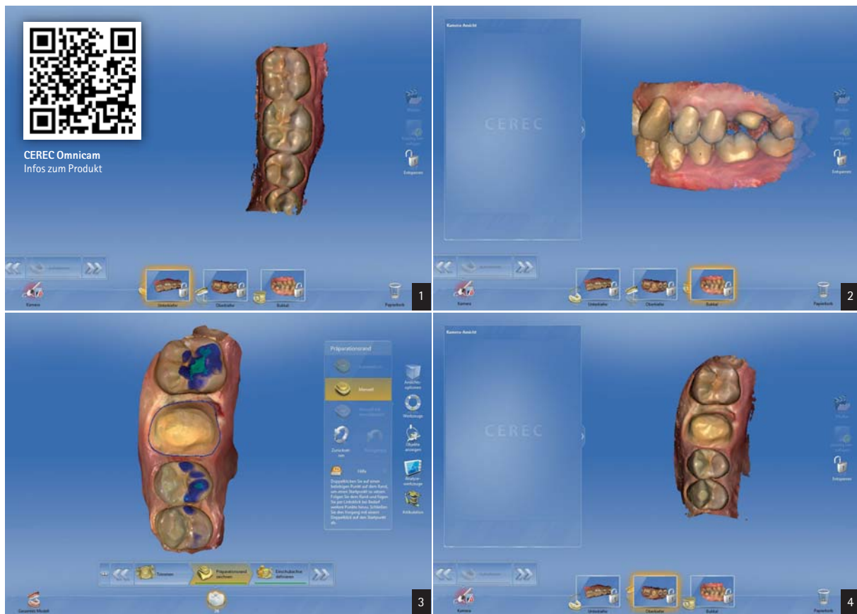
Abb. 1: Die CEREC Omnicam nimmt Zähne und Gingiva in natürlichen Farben auf. – Abb. 2: Mithilfe einer bukkalen Aufnahme werden Ober- und Unterkiefer in der Software einander zugeordnet. – Abb. 3: Mithilfe eines automatischen Kantenfinders zeichnet der Anwender die Präparationsgrenze im virtuellen Modell ein. – Abb. 4: Die Software errechnet automatisch einen biogenerischen Erstvorschlag, den der Anwender bei Bedarf individuell anpassen kann.
