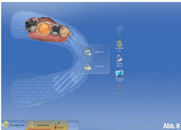
▲ Abb. 6 und 7: Bukkale Bissregistrierung. ▲ Abb. 8: Modellachse einstellen. ▲ Abb. 9: Einzeichnen der Präparationsgrenze.
