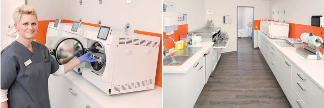
Abb. 5: Auch verpackte Instrumente, zum Beispiel in Kassetten, werden sehr schnell in dem Autoklaven Vacuklav 40 B+ sterilisiert. – Abb. 6: Thermodesinfektoren zur besseren Ergonomie auf Unterschrank. Reiner Bereich rechts.
