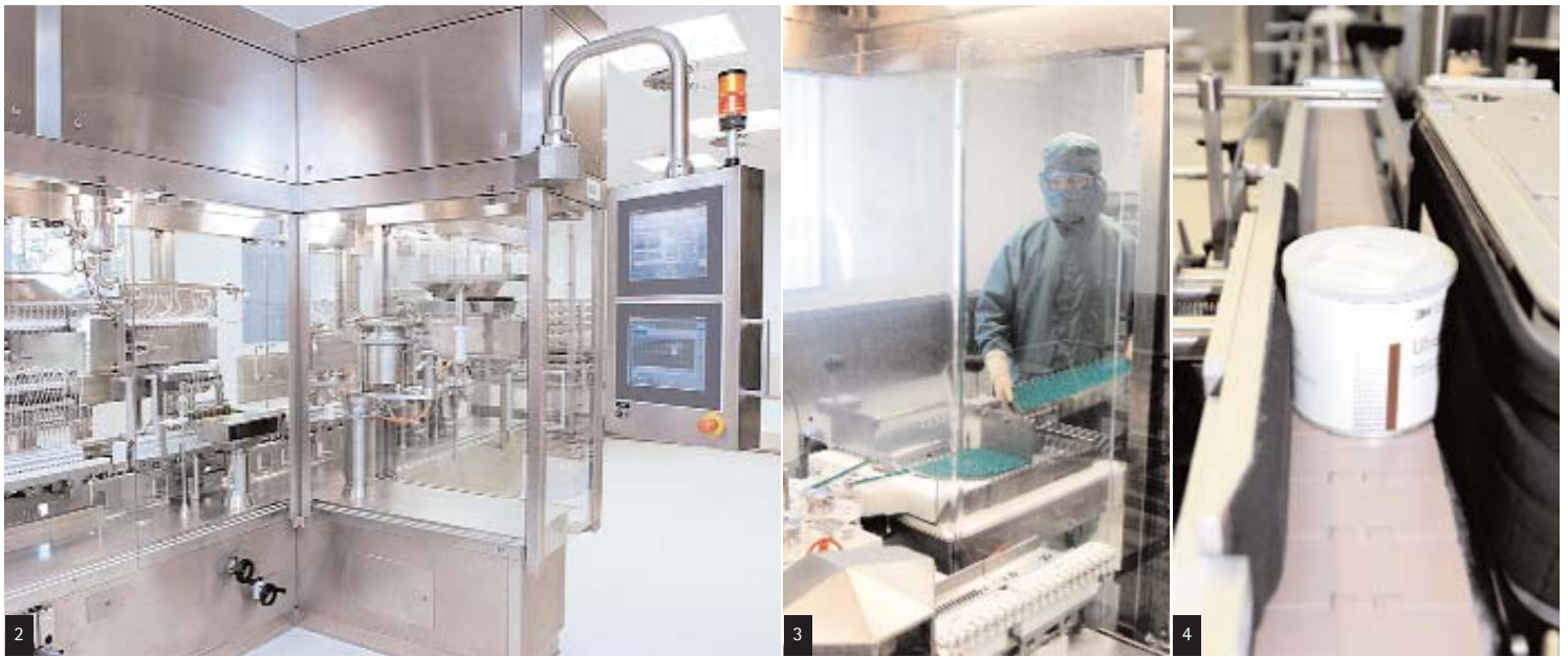
Abb. 2: Hochmoderne Abfüllanlage für Lokalanästhetika. – Abb. 3: Mitarbeiter bei der optischen Kontrolle der etikettierten Glaszylinder. – Abb. 4: Etikettierung der Metalldosen.
