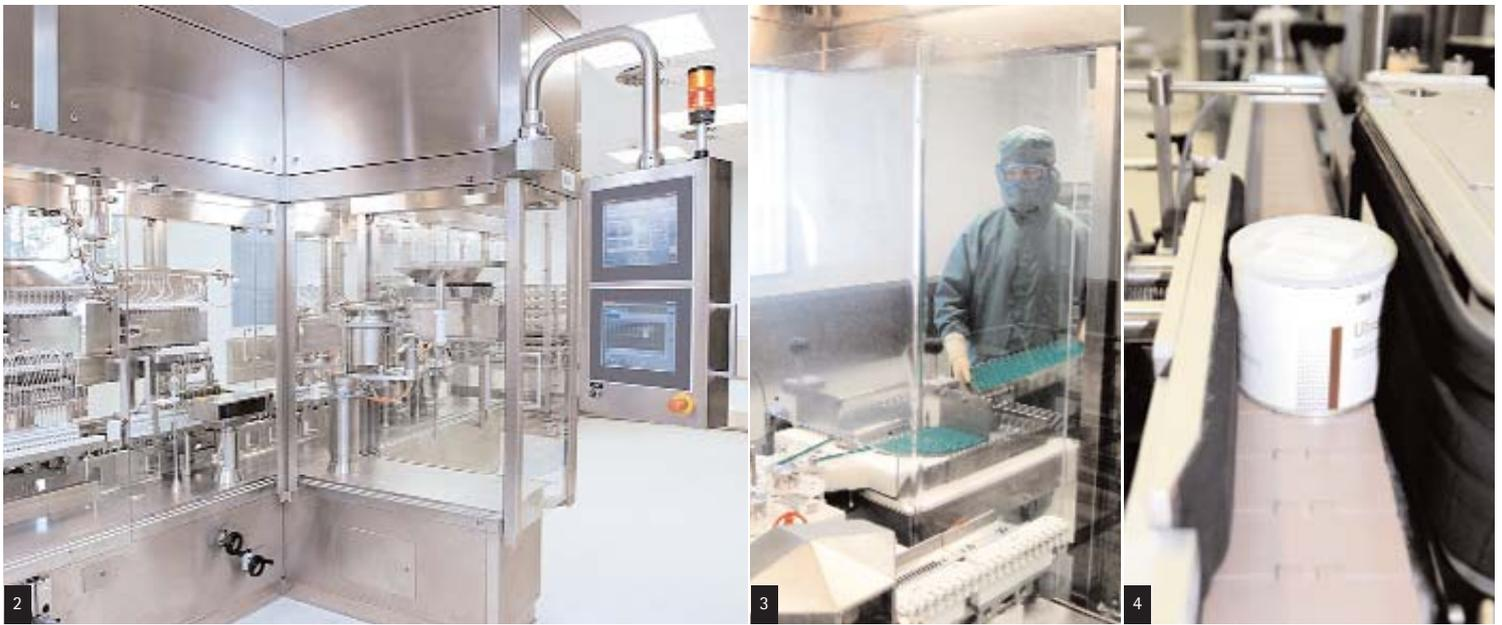
Abb. 2: Hochmoderne Abfüllanlage für Lokalanästhetika. – Abb. 3: Mitarbeiter bei der optischen Kontrolle der etikettierten Glaszylinder. – Abb. 4: Etikettierung der Metalldosen.
